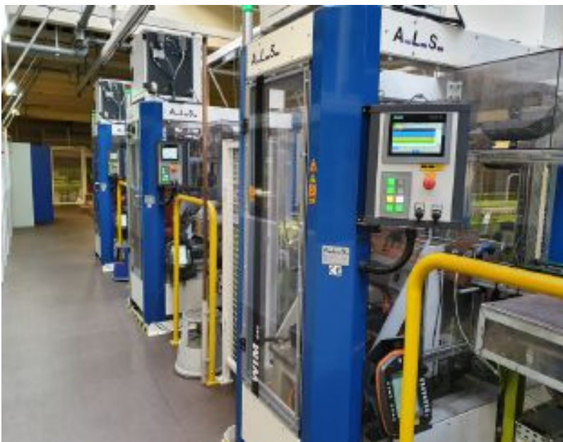
Im Bild drei Paketöffner der Modellreihe WIM von ALS in Reihe stehend. Rund 4,2 Millionen Pakete perforierten die Paketöffnungs-Systeme von ALS im Jahre 2018 im Hermes Versandzentrum.
